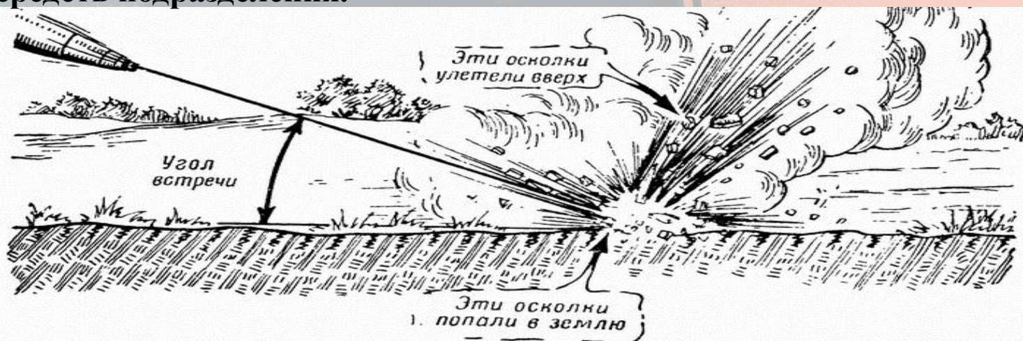
Рис. 103. Если граната падает на землю под небольшим углом, большая часть ее осколков не наносит поражения, так как часть осколков попадает в землю у самого места разрыва снаряда, а часть летит вверх
