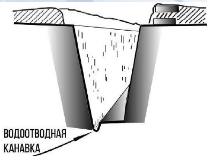
Рис. 2. Водоотводная канавка на дне траншеи
